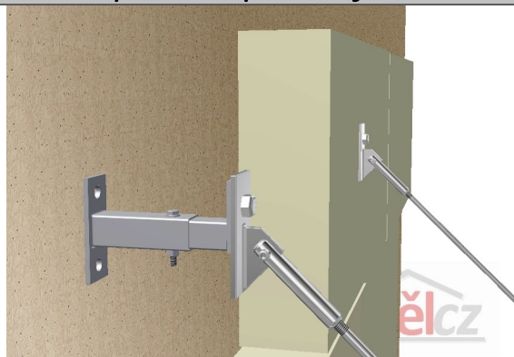
Kotvicí konzole č3 do zateplené fasády
